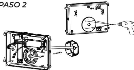
**PASO 2)** Taladre orificios de instalación en la parte inferior de la luz, y pegue la estera EVA. Afloje el tapón de la placa inferior, pase el cableado a través del orificio y atornille la cubierta inferior con la caja de conexiones a la pared.
